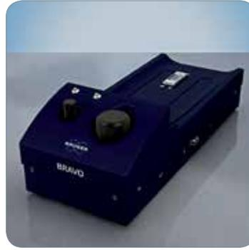
Док-станция используется для подзарядки и хранения устройства, а также для переноса данных.
